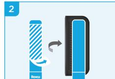
Quita el revestimiento de rayas de la cinta adhesiva de doble faz. Presiona la cinta adhesiva en la parte inferior del reproductor de streaming.
