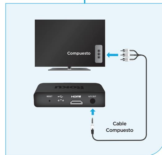
Si tu TV no tiene una conexión HDMI, utiliza el cable compuesto incluido.
